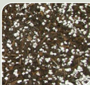
Substraatmengsel t.b.v. het pneumatisch injecteren: 50% Agra Perlite, geëxpandeerd vulkanisch gesteente = bodemstructuurverbeterend. 50% schimmelgedomineerde Humuscompost (fractie 3-8 mm) = aanvulling bodemleven/ bodemvoedselweb.
